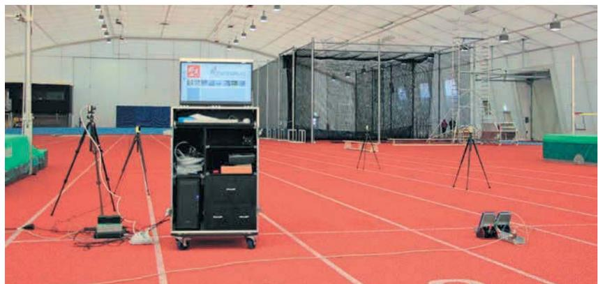
Der Messaufbau „Sprint“ mit Sprint-Startblock, Videokameras und Lichtschranken.
